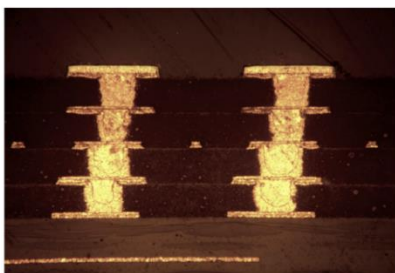
스캔 결과 4개의 stacks microvias와 인접한 정밀하게 에칭된 트레이스가 확인됩니다.
